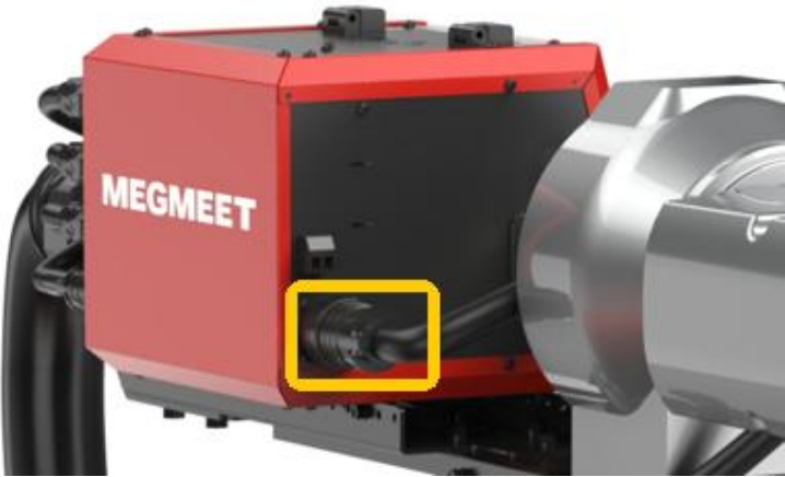
图 2-7 伺服焊枪 19 芯通讯线缆示意图
